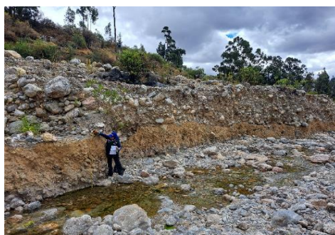
FOTOGRAFIA N°02: Verificación de la altura de talud en el margen izquierdo del río Huancapi, que viene erosionándose fluvialmente afectando a áreas de cultivo.
